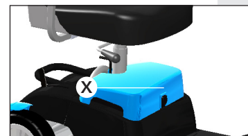
Contact chargeur batterie
