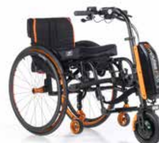
Aandrijfwiel, 8.5", massieve band, voor koppeling rolstoelen met wegzwenkbare beensteunen
